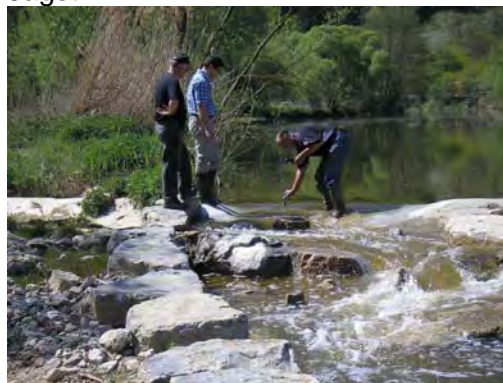
Abflussmessung im neuen Fischpass durch den Fischereisachverständigen beim RP Stuttgart
